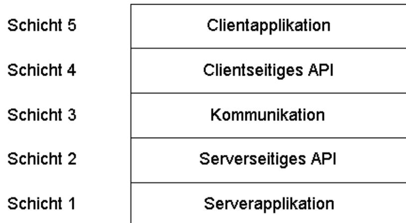
Abb. 3: Software-schichten des Kontrollsystems
